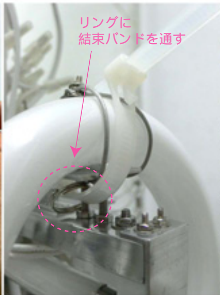
5.6.7.ワイヤでランプを固定した後、さらにランプを安定させるため結束バンドを使用します。器具の2本の脚（ネジ）の奥部分のリングに結束バンドを通し、結束バンドでランプを固定します。 *結束バンドはリユース可能タイプで、爪を押すとバンドを外すことができます。
